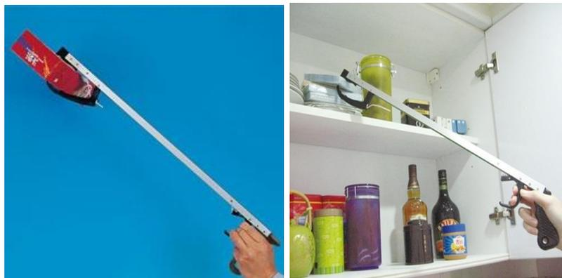
Захват изготовлен из алюминиевого сплава, с пластмассовой ручкой и металлическим зажимом для предметов.
